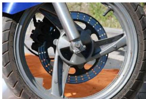
Asimismo, con los **frenos de disco** debe **vigilar** que el **nivel del líquido** del circuito debe coincidir con la marca indicada en el depósito. Si el nivel está por debajo, el circuito tiene alguna pérdida y debe localizarla o repararla antes de rellenarlo. En el caso de **frenos de tambor**, habituales en scooter y motos de pequeña cilindrada en el eje posterior, se debe **regular la tensión del cable** hasta recuperar el tacto adecuado.
