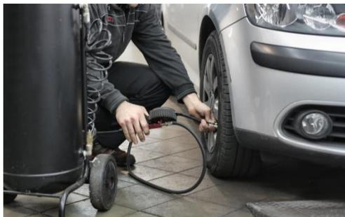
Revisar si los neumáticos del coche **tienen la presión adecuada** (aconsejada por el fabricante del automóvil), y comprobar la profundidad del dibujo de la cubierta, así como posibles desgastes irregulares, es una **operación de mantenimiento sencilla** que los expertos aconsejan **realizar una vez al mes**, y siempre antes de emprender un largo viaje o con el maletero lleno. Incrementaremos la seguridad y el confort, y reduciremos el consumo.
