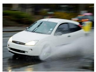
Es un fenómeno físico que ocurre cuando las ruedas del automóvil no se adhieren a la carretera a causa de la Iluvia. Cuando esto sucede, en los días de lluvia intensa, el conductor pierde el control sobre vehículo, y a gran velocidad las consecuencias pueden ser fatales.
