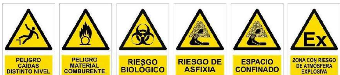
Señales de advertencia (RD 485/97)
