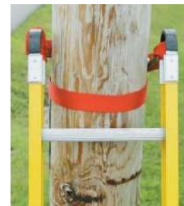
Fijación superior con sistema específico
