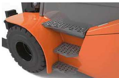
Estribos, peldaños acceso
